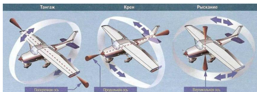
Рис. 22. Тангаж, крен, рысканье.
