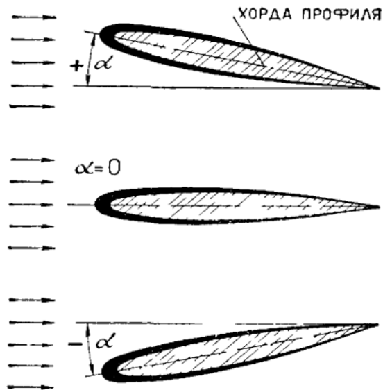
Рис. 32. Угол атаки профиля
