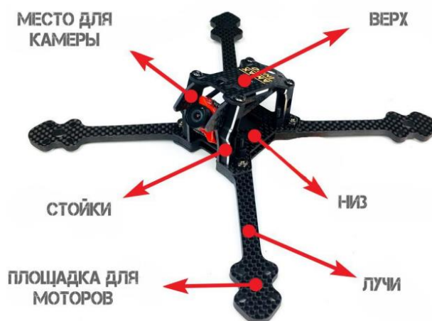
Рис. 76. Рама беспилотника с основными элементами конструкции
